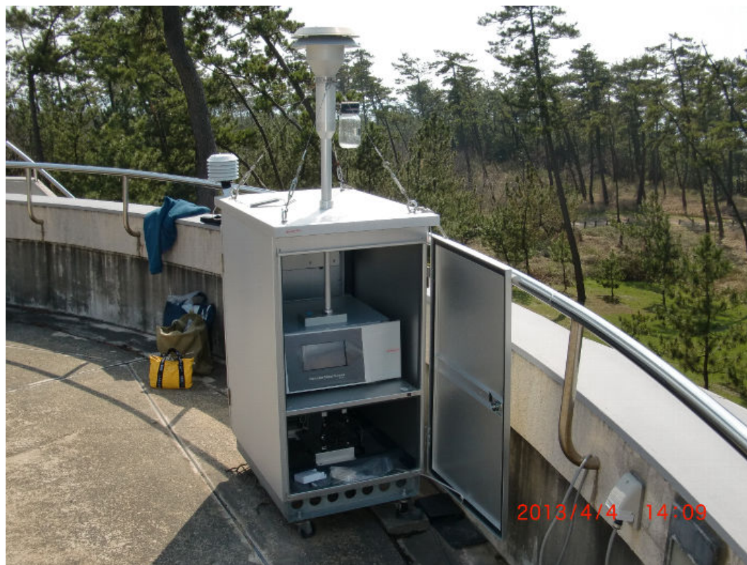
羽咋での観測装置 (紀本電子工業 PM712)
